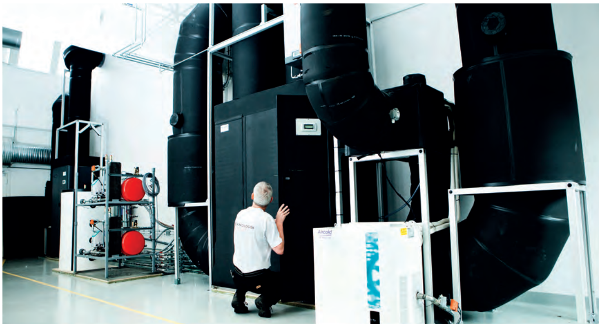
Teknologisk Institut kan i deres klimakamre i Århus teste varmepumper for bl.a. effektivitet, ydelse og lyd. Foto: Teknologisk Institut
