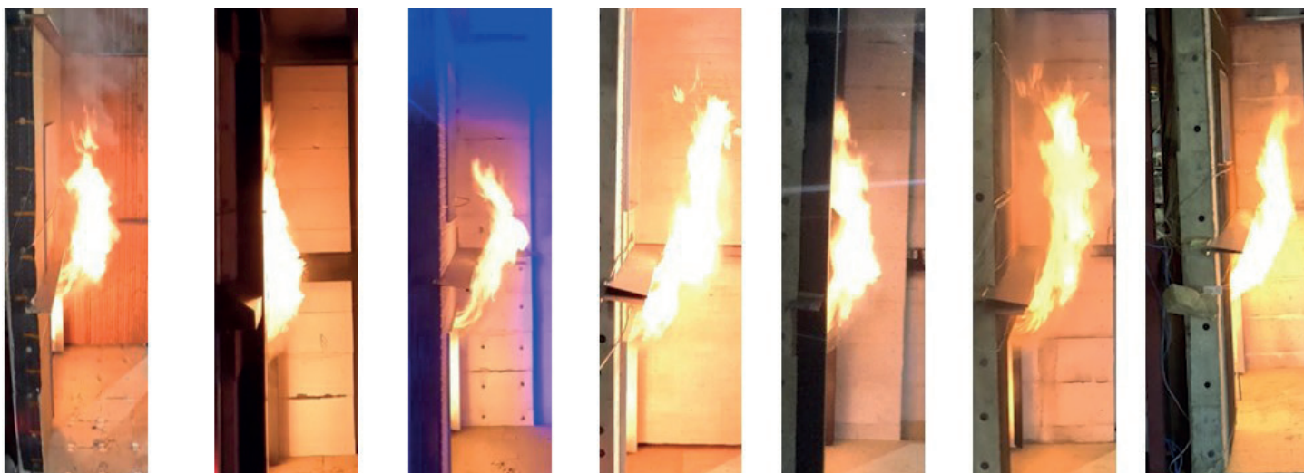
Sammenligningsbillede fra test 1-7 af flammeafbøjers effekt, 1 minut inde i testen.
